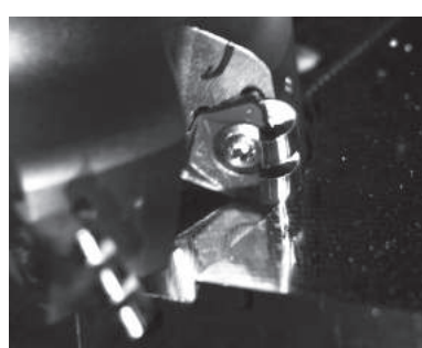
Sauber gerollte Späne (Dieses Foto wurde mit einer Hochgeschwindigkeitskamera aufgenommen.)
