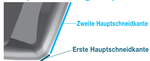
<Schnittbedingungen> Werkstückmaterial: FCD450 mit 4 Bohrungen V_c=300 m/min f_z=0.5 mm/Z a_p=2.0 mm Nass
