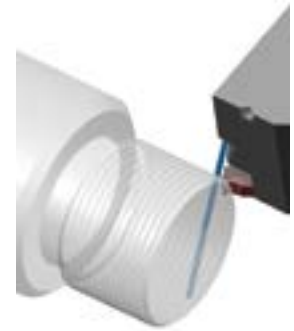
Beispiel für das Hängenbleiben von Spänen
