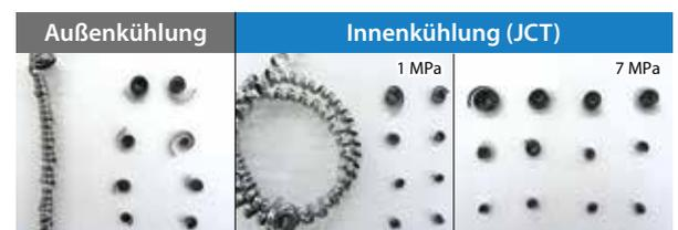
Schnittbedingungen:  $n = 780 \text{ min}^{-1}$  (konstant),  $V_c = 120 \text{ m/min}$ ,  $f = 0,08 \text{ mm/U}$ ,
