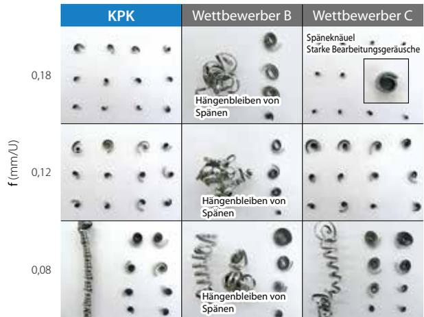
Schnittbedingungen:  $n = 780 \text{ min}^{-1}$  (konstant),  $V_c \sim 120 \text{ m/min}$ , Nassbearbeitung (Außenkühlung)
