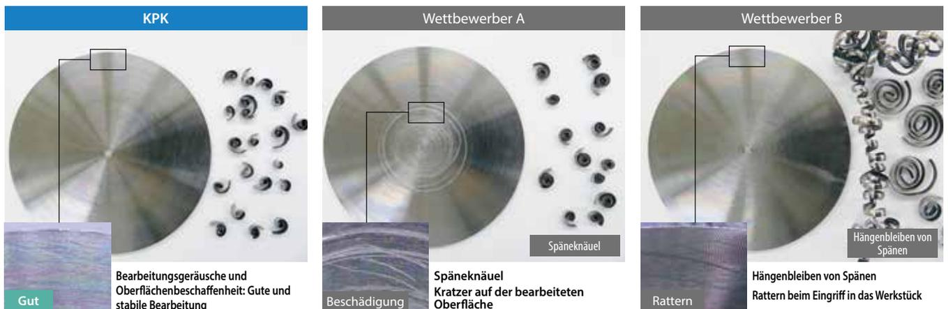
Schnittbedingungen:  $n = 320 \text{ min}^{-1}$  (konstant),  $V_c = \sim 100 \text{ m/min}$ ,  $f = 0,12 \text{ mm/U}$ , Nassbearbeitung (Außenkühlung) Werkstück: 34CrMo4 ( $\varnothing 100$ ) Schnittbreite: 3 mm (PM-Spanleitstufe)
