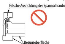
Wenn das Spannschraubenset umgekehrt eingebaut wird, bildet sich ein großer Spalt zwischen dem Werkzeughalterblock-Körper und dem Spannschraubenset, wie in der linken Abbildung dargestellt. Wird das Produkt weiterhin genutzt, kann das Schwert abbrechen. Installation erneut in der richtigen Ausrichtung durchführen.
