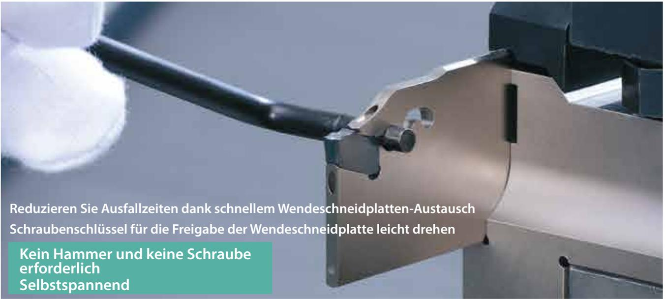
Reduzieren Sie Ausfallzeiten dank schnellem Wendeschneidplatten-Austausch
